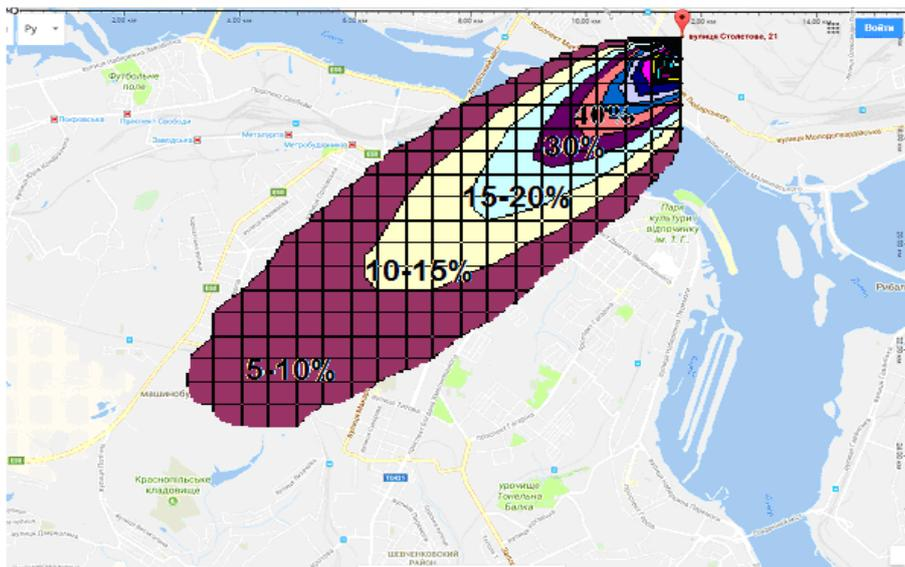
Рис. 1. Зона загрязнения диоксидом азота  $t=30$  с
