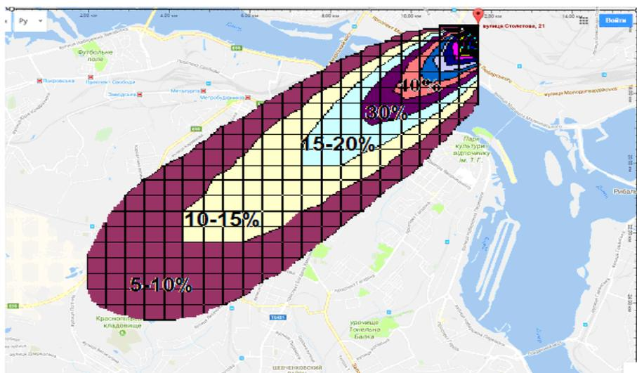
Рис. 3. Зона загрязнення диоксидом азота  $t=52,5$  с
