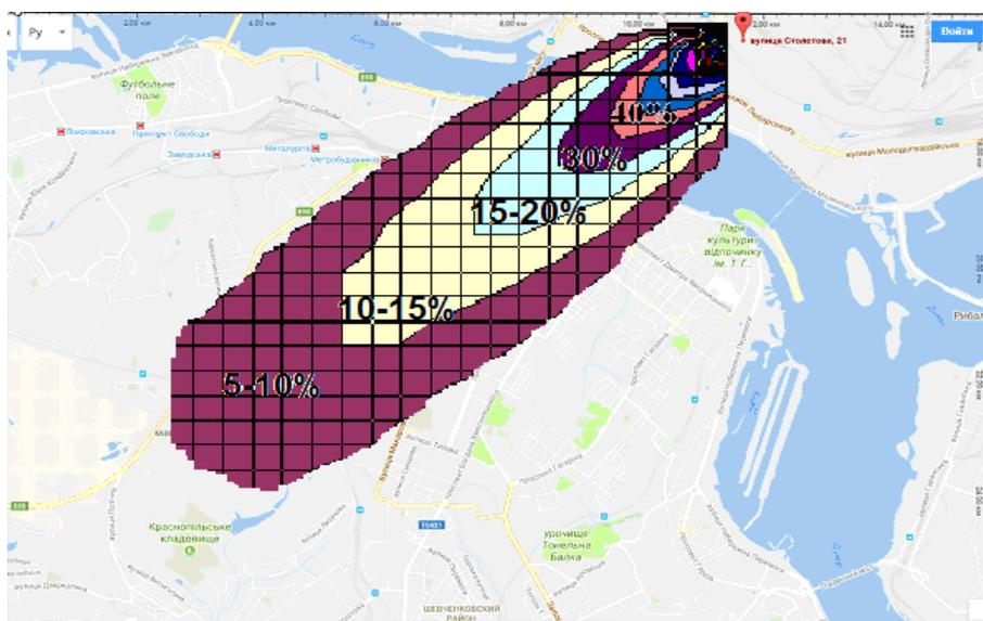
Рис. 2. Зона загрязнения диоксидом азота  $t=40,5$  с
