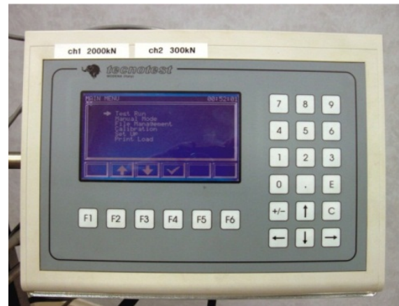
Рис. 2.13. Блок управління випробувальної машини
