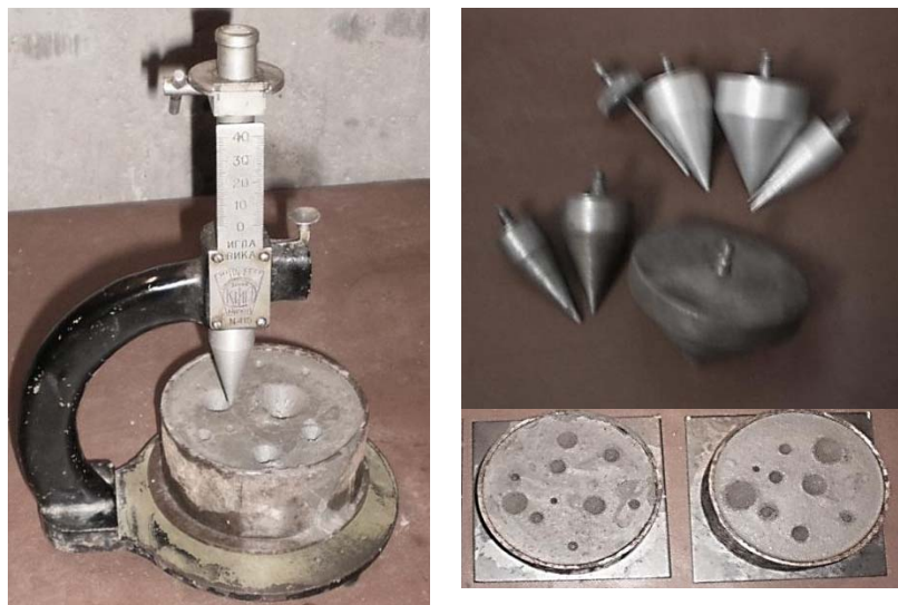
Рис. 2.8. Прилад Віка з набором конусів і зразки тампонажних розчинів на основі шахтних порід
