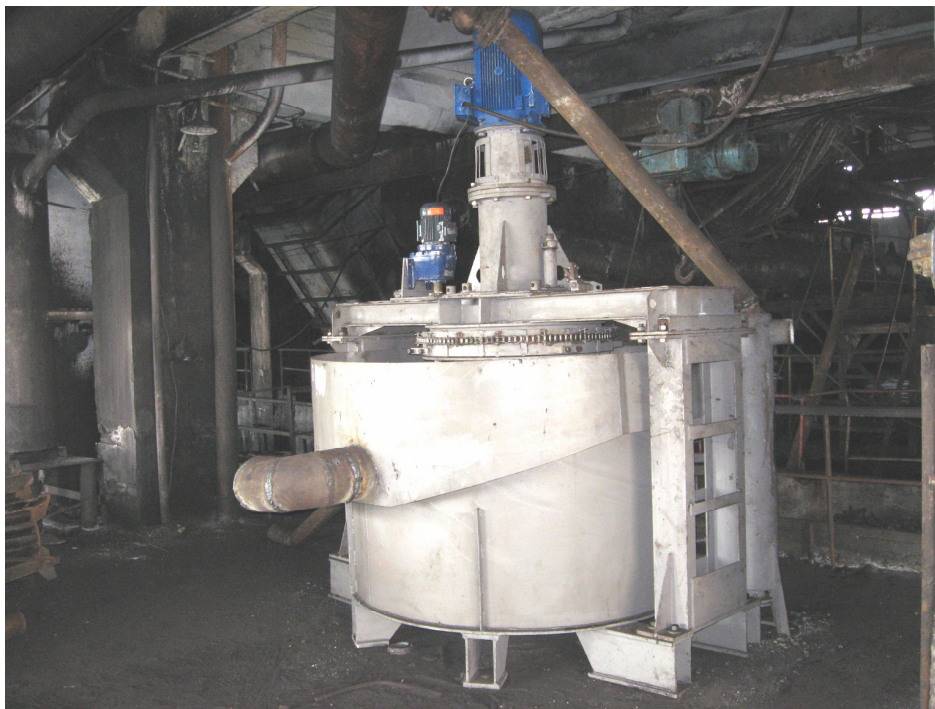
Рис. 1. Общий вид экспериментального образца радиальной флотомашины МФР-2У
