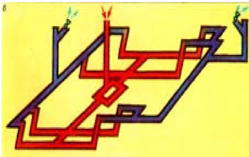
Рис.16.2. Фланговая схема проветривания шахты
