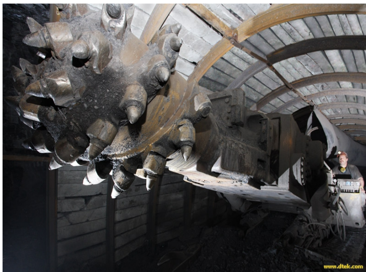
Рис.6.6. Проведение горной выработки комбайном
