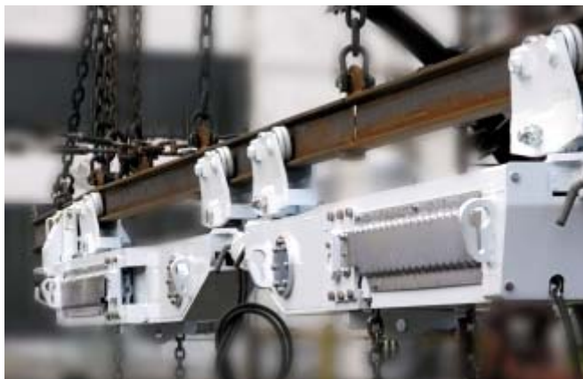
Рис.15.11. Гидравлическое устройство для перевозки крепи УПКГ-12ДУО
