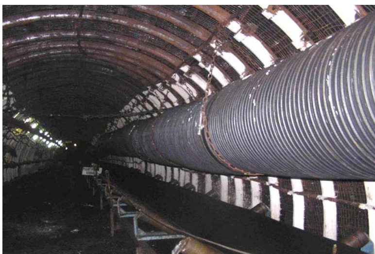
Рис.15.2. Ленточный конвейер в тупиковой горной выработке
