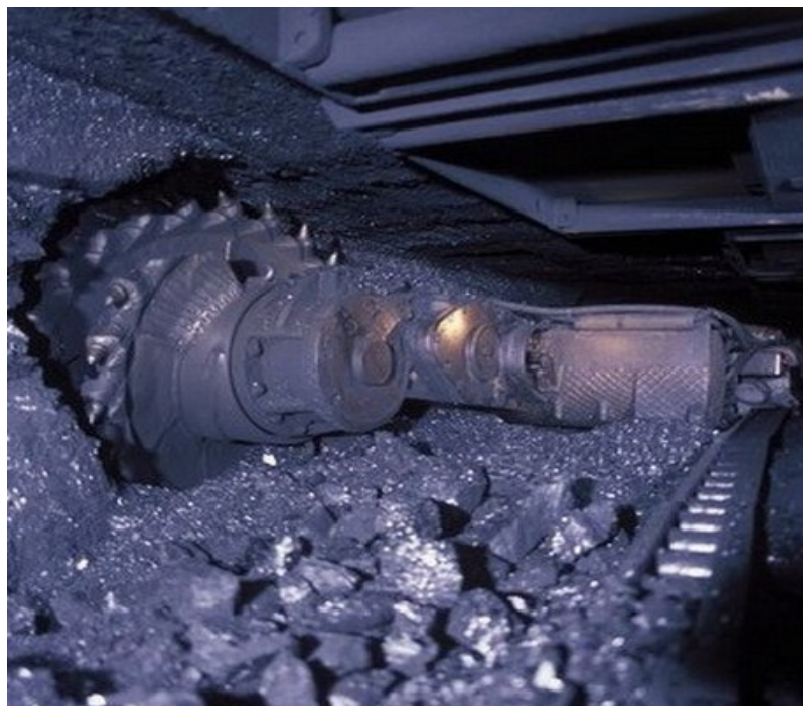
Рис.9.1. Выемка угля комбайном в лаве
