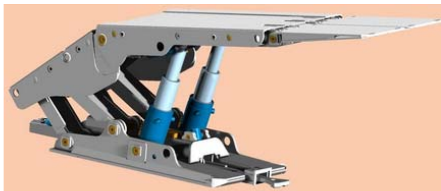
Рис. 9.3.2. Крепь агрегатированная щитовая двухстоечная КДД
