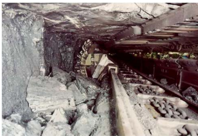
Рис. 9.11 Лава, оборудованная струговым комплексом
