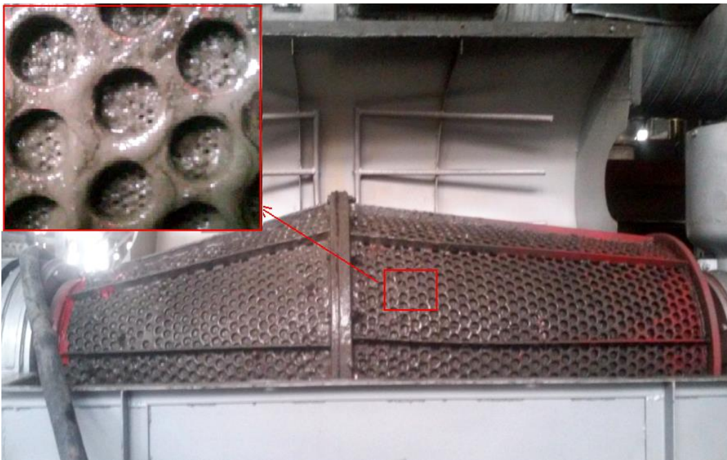
Рис. 3. Емкость классифицирующая, фильтровальная поверхность барабана ротора
