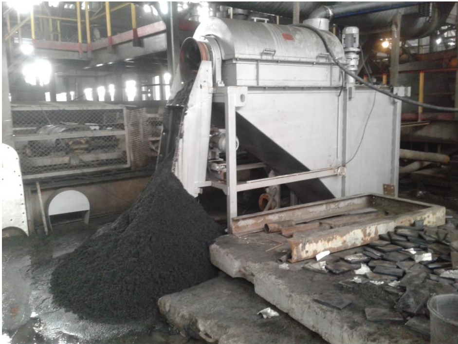
Рис. 2. Выгрузка надрешетного продукта емкостью классифицирующей
