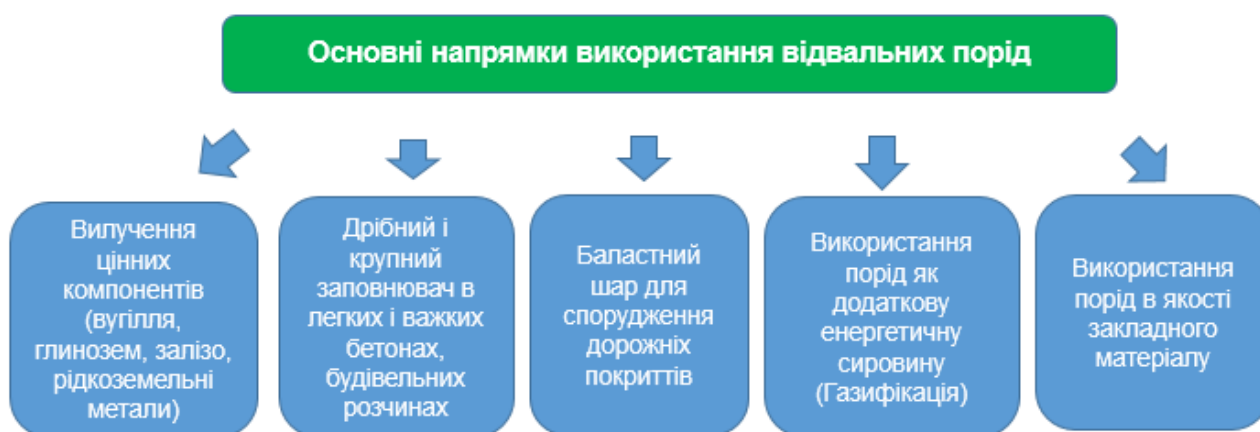
Рисунок 3 – Основні напрями промислового поводження з відвальними породами
