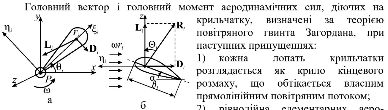
Рис. 6 – Рівнодійна R_i аеродинамічних сил, діючих на i -лопать: а – дія на лопать; б – розташування в характерному перерізі лопаті
