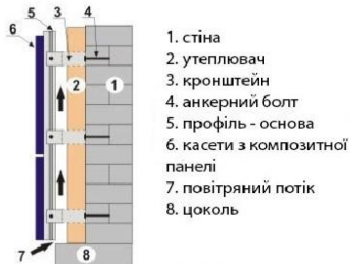
Рис 1. Схема вентиляльованого фасаду
