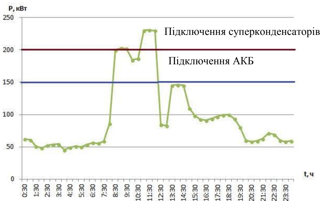
Рис. 3.5 – Графік навантаження з включенням гібридного накопичувача
