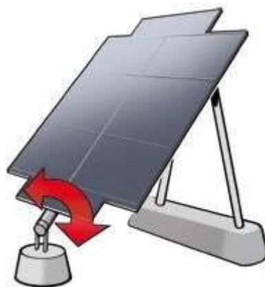
Рис. 2.3 - Одноосьовий трекер з полярною віссю обертання.
