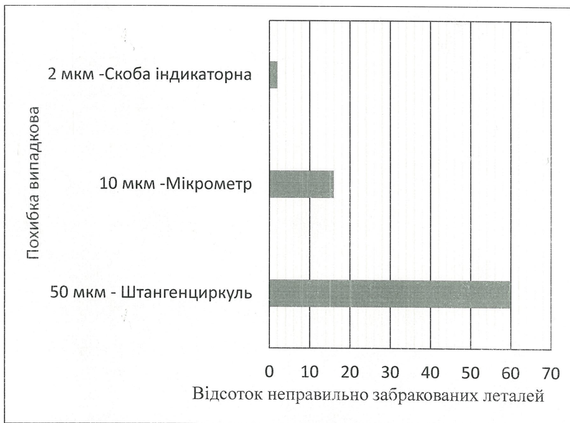
Рисунок 4.3 – Залежність відсотку неправильно забракованих деталей від точності вимірювального засобу
