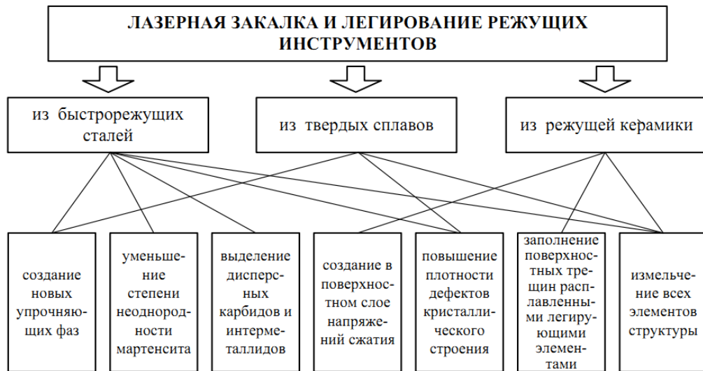
Мал. 4.18 Основні механізми лазерного зміцнення інструментів з різних інструментальних матеріалів
