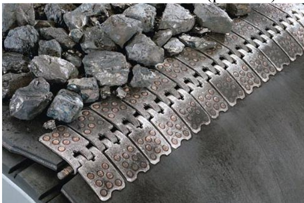
Рис.4.5 Один з видів механічного з'єднання кінців конвеєрної стрічки
