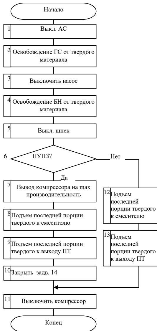
Рис. 2. Блок-схема алгоритма останова экспериментального ГЭГ
