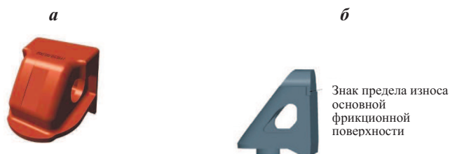
Рис. 4.12. Клин амортизатора: а) тележки ЦНИИ-ХЗ; б) тележки ZK1-E
