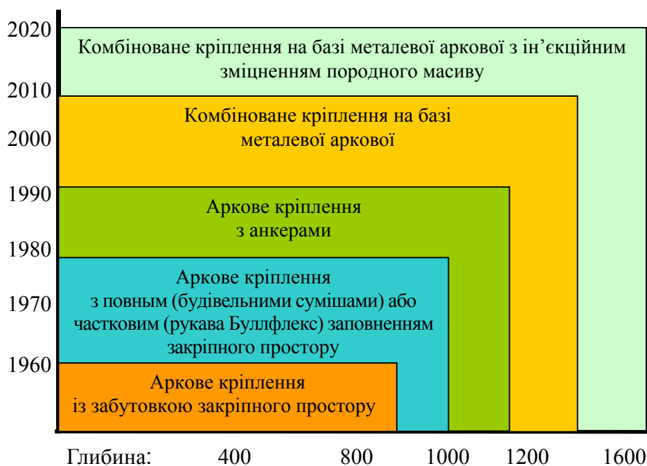
Рис. 1. Розвиток систем кріплення із зростанням глибини розробки [2]
