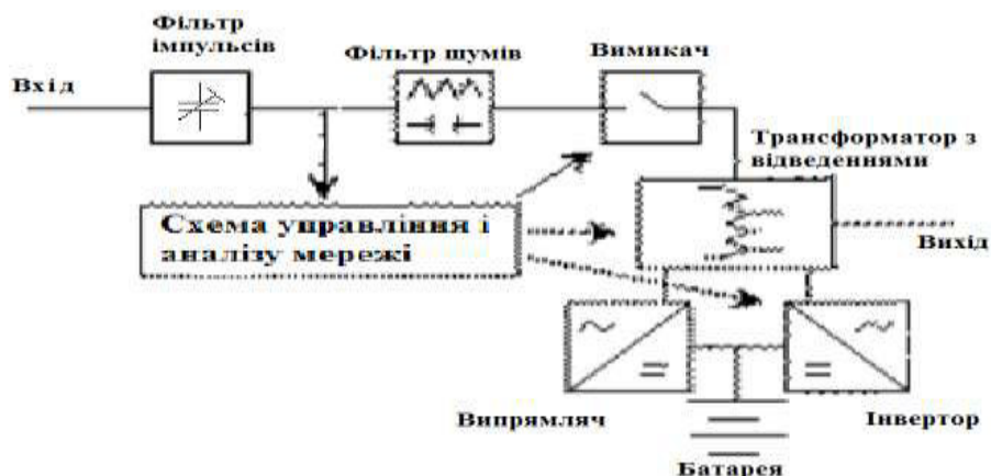
Рисунок 2.10 — Структурна схема ДБЖ, що взаємодіє з мережею
