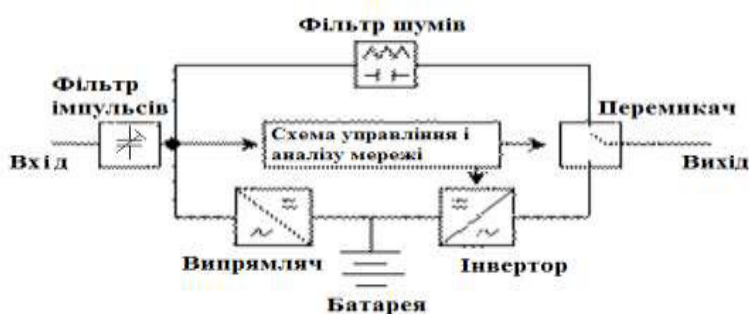
Рисунок 2. 6 - Загальна структурна схема резервного ДБЖ
