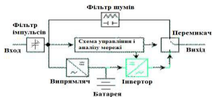
Рисунок 2.9 - Структурна схема роботи ДБЖ з перемиканням від батареї
