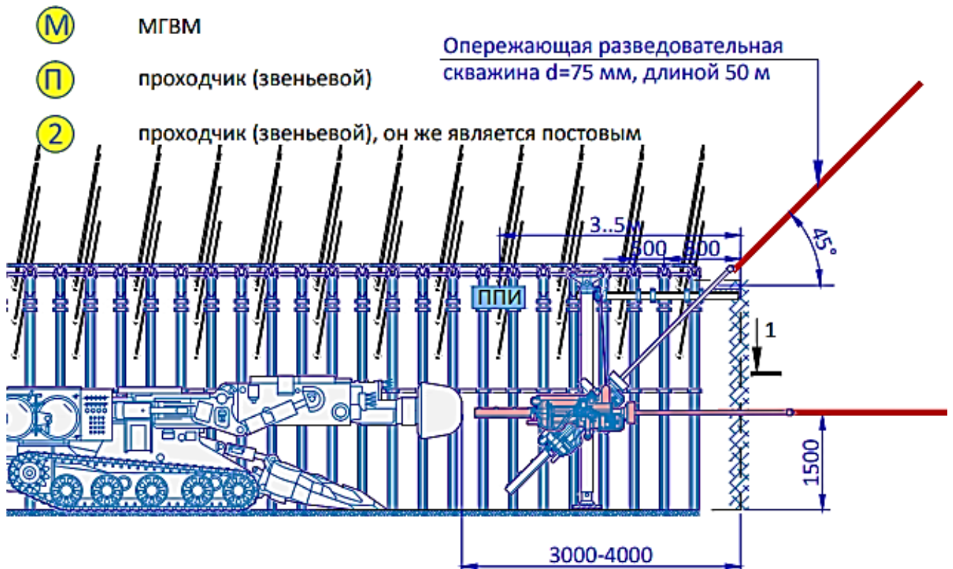
Рисунок 2.3. Схема виконання буріння розвідувальних свердловин
