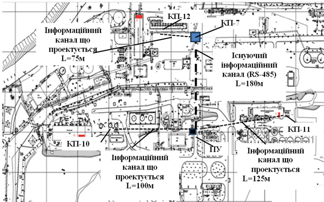
Рисунок 5.2 – Розміщення компонентів інформаційної системи на плані об'єкта. Схема загальна
