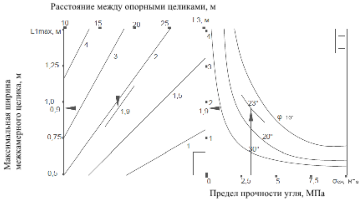
Рисунок 2.2 - Номограмма для определения максимально допустимой ширины l_{1 \max} межкамерного целика
