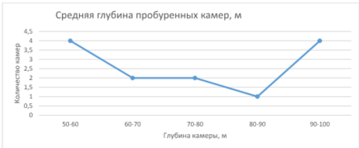
Рисунок 1.1 – График изменения средней глубины пробуренных камер за период приёмочных испытаний в ВКШ-02 ш. «Аютинская»
