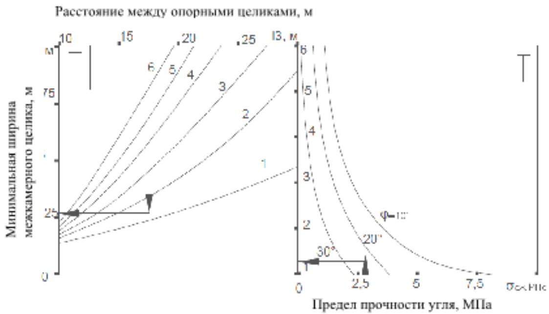
Рисунок 2.1 - Номограмма для определения минимально допустимой ширины l_{1 \min} межкамерного целика
