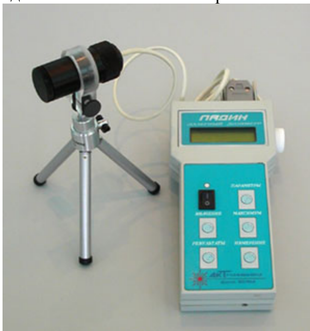
Рис. 3.21. Дозиметр для контролю лазерного випромінювання "ЛАДИН"
