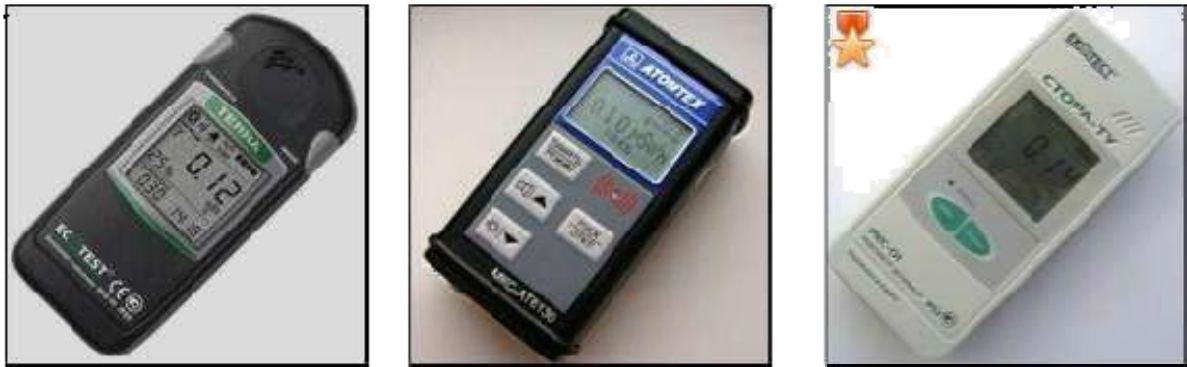
Рис. 3.23. Прибори для радіометричного і дозиметричного контролю: МКС-0,5 «Терра», МКС-АТ6130 і РКС-01 "Стора-ТУ"
