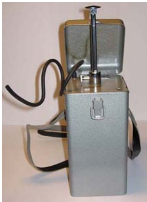
Рис. 3.7. Універсальний газоаналізатор УГ-2
