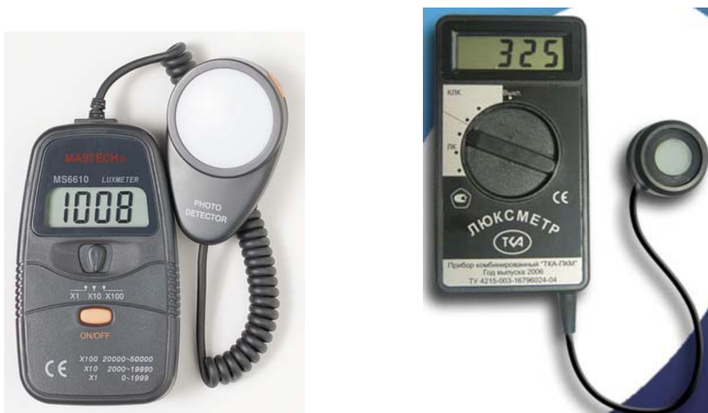
Рис. 3.16. Загальний вигляд цифрових люксметрів: а) - MS 6610; б) - «ТКА-ЛЮКС»
