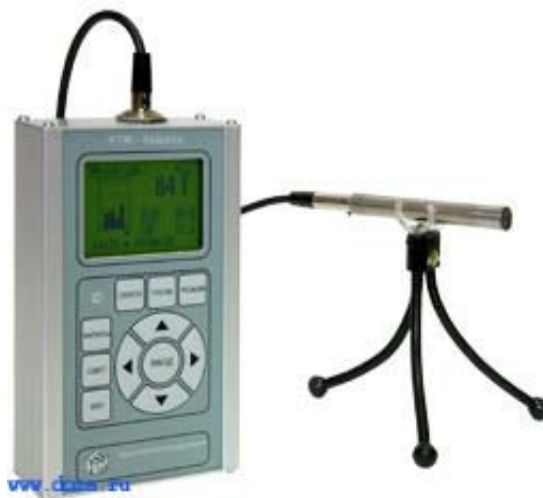
Рис. 3.17. Прибор для контролю шуму – шумомір ШІ-01
