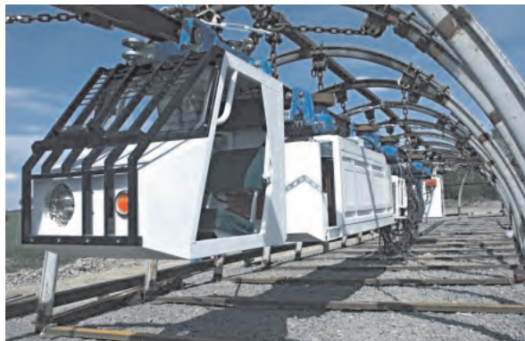
Рисунок 16.10 – Дизель-гідролічний локомотив ДПЛ-120
