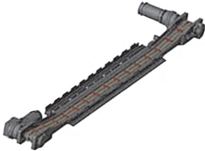
Рисунок 16.4 – Конвеєр скребковий СП26У
