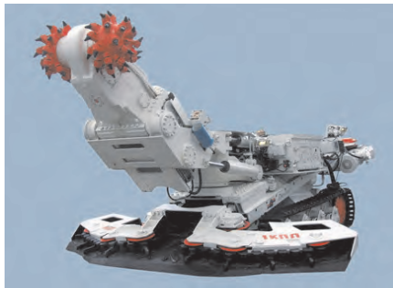
Рисунок 10.30 – Комбайн прохідницький КПЛ
