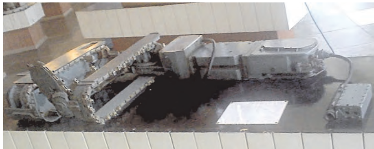
Рисунок 3.3 – Виїмковий комбайн «Донбас» з кільцевим баром і ріжучою без перекосу штангою з кільцевим вантажником
