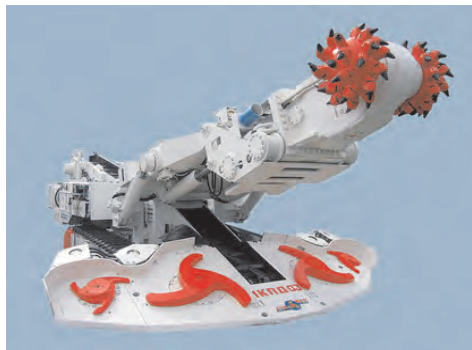
Рисунок 10.32 – Комбайн прохідницький КПД
