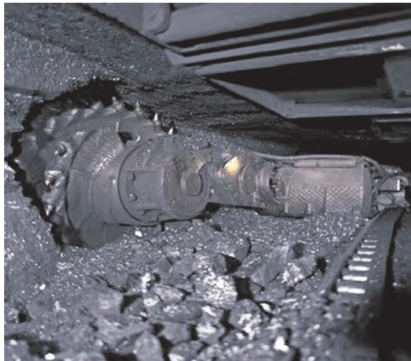
Рисунок 10.1 – Виймання вугілля комбайном в лаві
