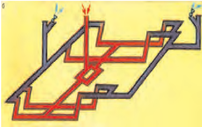
Рисунок 17.2 – Флангова схема провітрювання шахти
