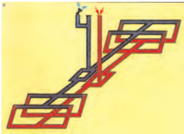
Рисунок 17.1 – Центральна схема провітрювання шахти
