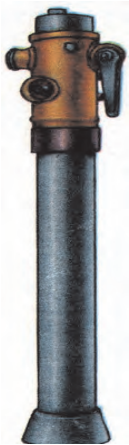
Рисунок 11.3 – Індивідуальний гідравлічний стояк ГС
