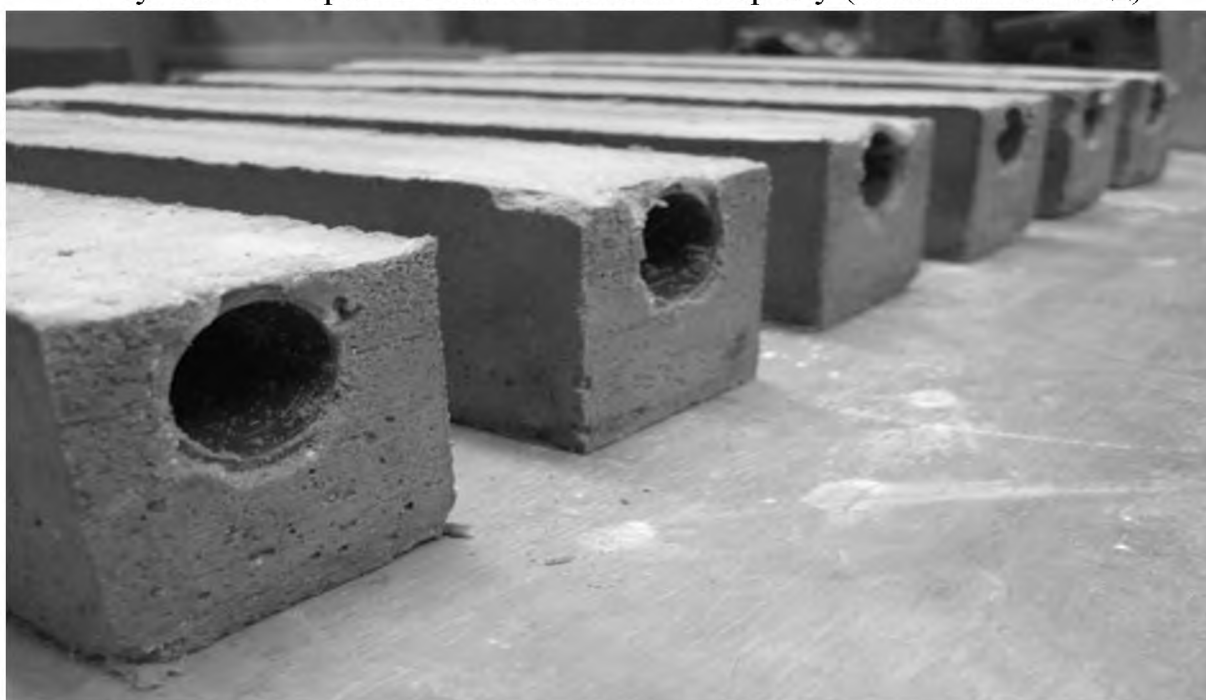
Рисунок 4.6 – Улаштована в бетонному зразку полімерна трубка (приклад)
