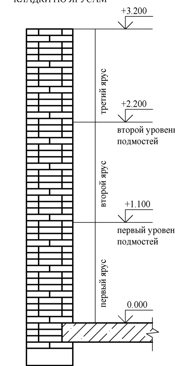
СХЕМА РАЗБИВКИ КИРПИЧНОЙ КЛАДКИ ПО ЯРУСАМ
