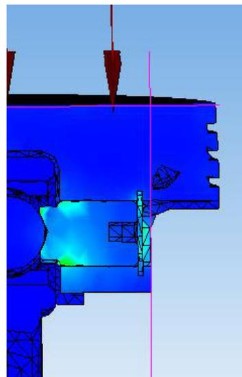
Рис. 8 Картограмма напряжений в предлагаемом техническом решении
