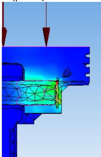
Рис. 7 Картограмма напряжений в классической схеме КШМ
