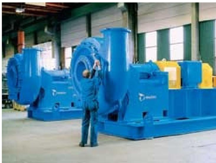
Рисунок 2 – Насос Metso Minerals в процессе сборки [1]
