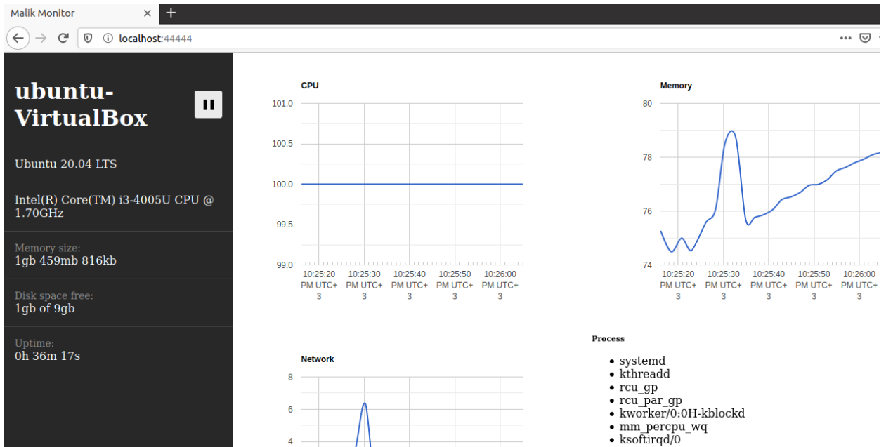
Рисунок 3.5 – Веб-інтерфейс розробленої системи моніторингу стану серверного обладнання
