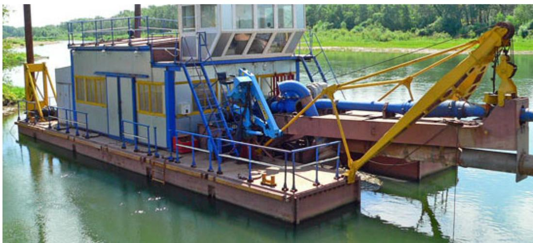
Рисунок 1 - Землесосный снаряд «С-42А»
