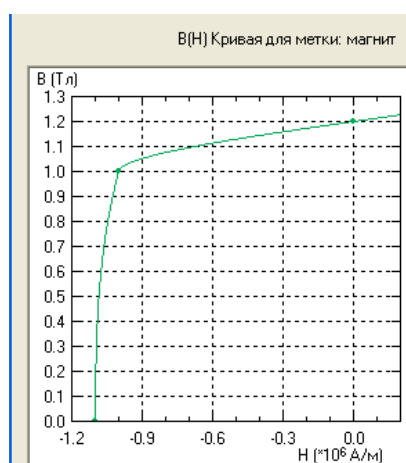
Рисунок 7 – Часть петли гистерезиса для постоянного магнита на основе соединения NdFeB, реализованной в программе Elcut
