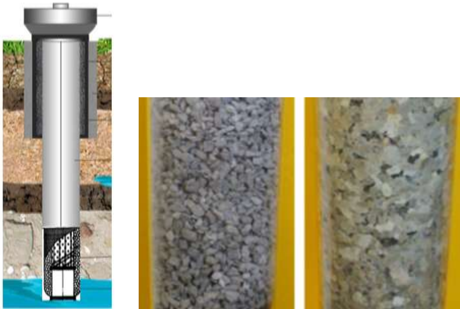
Рисунок 2.11. Схема фільтра з піщано-гравійних сумішей
