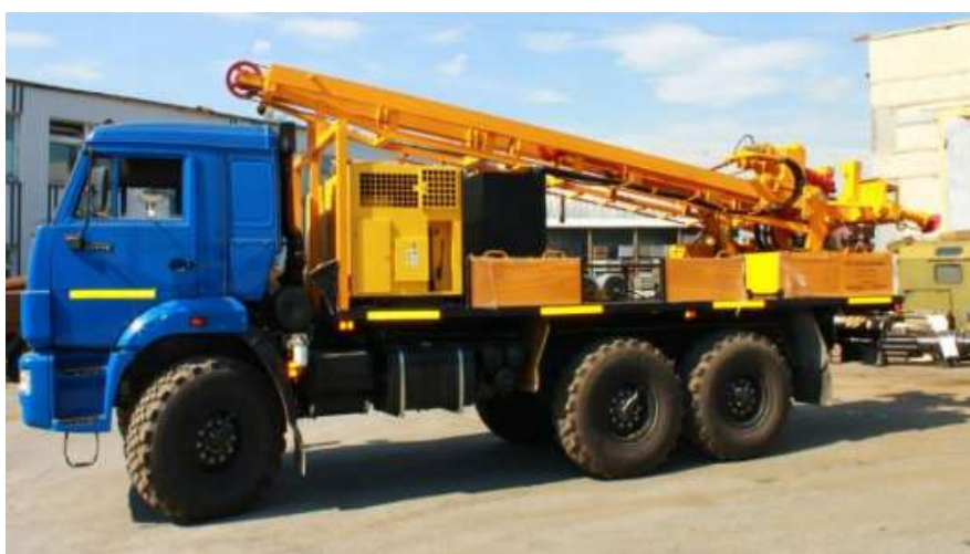
Рисунок 2.2. Бурова установка УРБ-2А2
