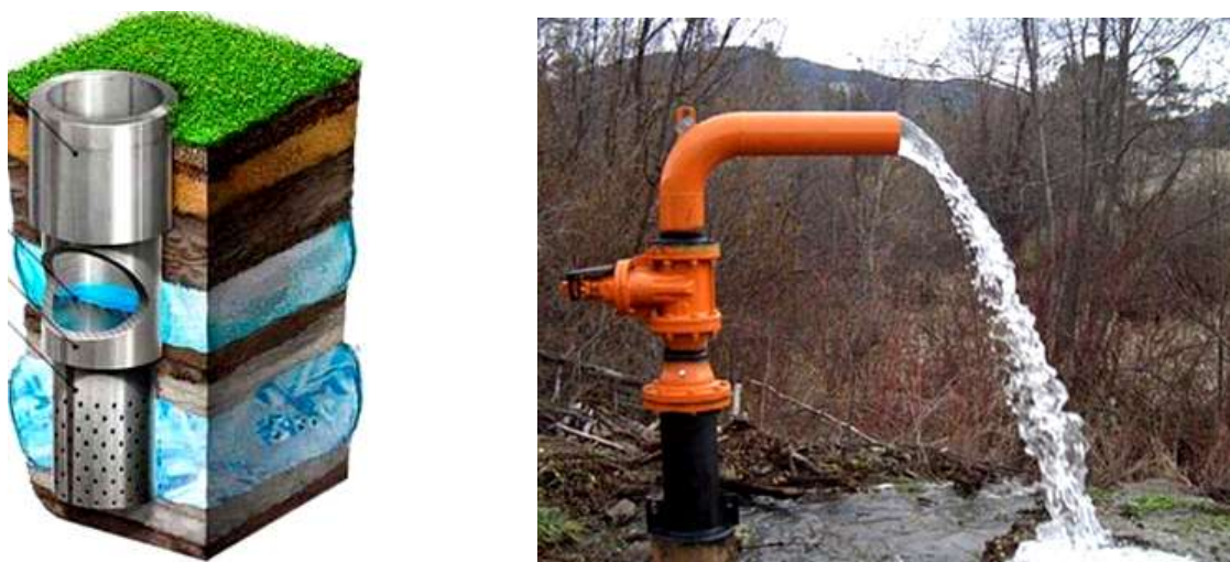
Рисунок 2.9. Гирлове виконання гідрогеологічних свердловин
