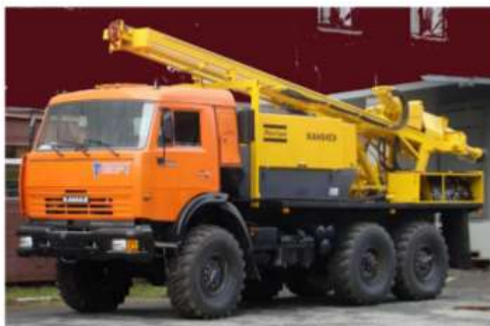
Рисунок 2.2. Самохідний буровий агрегат УРБ-2А2Д (загальний вигляд)
