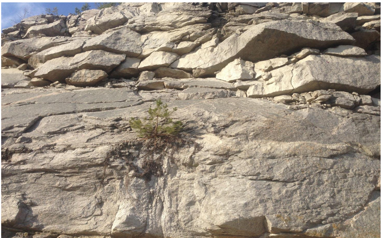
Рис. 3.3 Форма уступу, яка складена різноблочними породами з горизонтальною тріщинуватістю в верхній частині уступу
