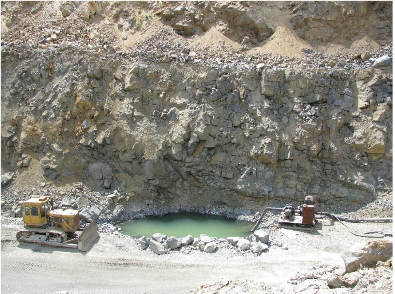
Рис. 2.3 Бульдозер ДЗ 171-1-03 у зумпфа об'ємом 180 м 3 та насос Д-320 продуктивністю 300 м 3 /годину
