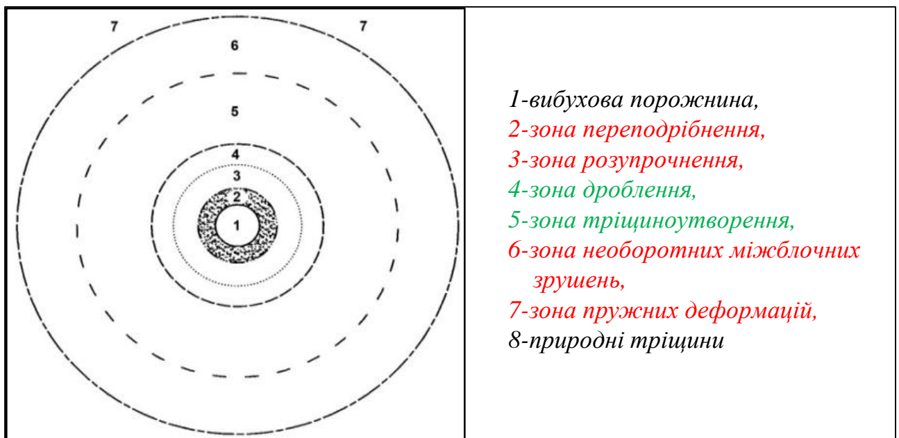
Рис. 3.4 Зони з різною руйнівною дією вибуху
