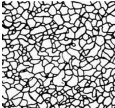
Рис.5. Мікроструктура технічного заліза (ферит), х 100.
