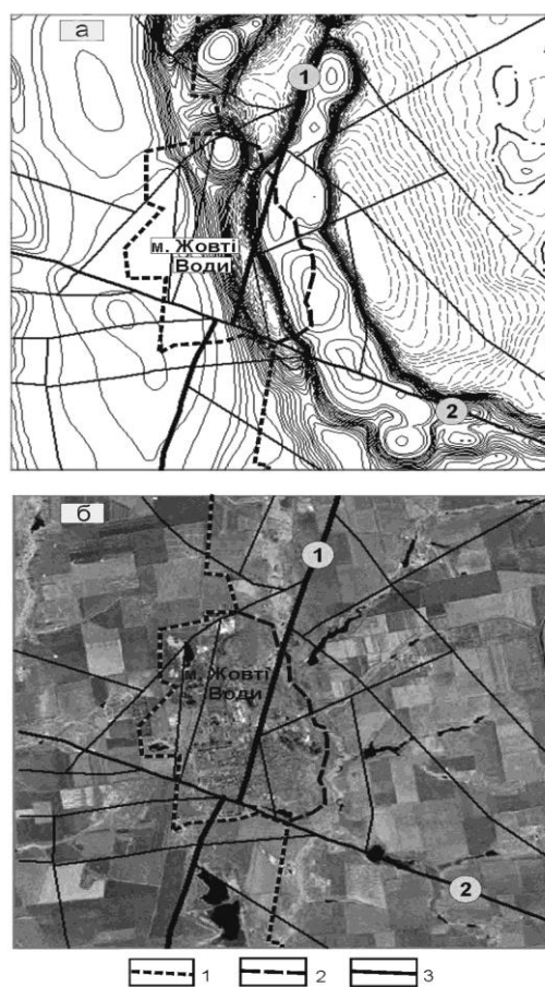
Рис.1.2 Схема аномального магнітного поля \Delta T_a (а) і космознімок (б) району м. Жовті Води з основними елементами розривної тектоніки докембрію.
