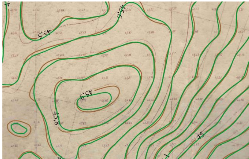
Рисунок 3.7 – Фрагмент карти фактичних значень сили тяжіння і ізолінії сили тяжіння побудовані методом Criging (коричневим кольором) і мінімальної кривизни (зеленим кольором)
