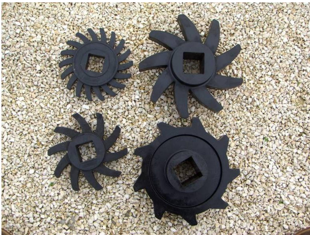
Рис. 3.3. Багатопальцеві диски валкового грохоту.
