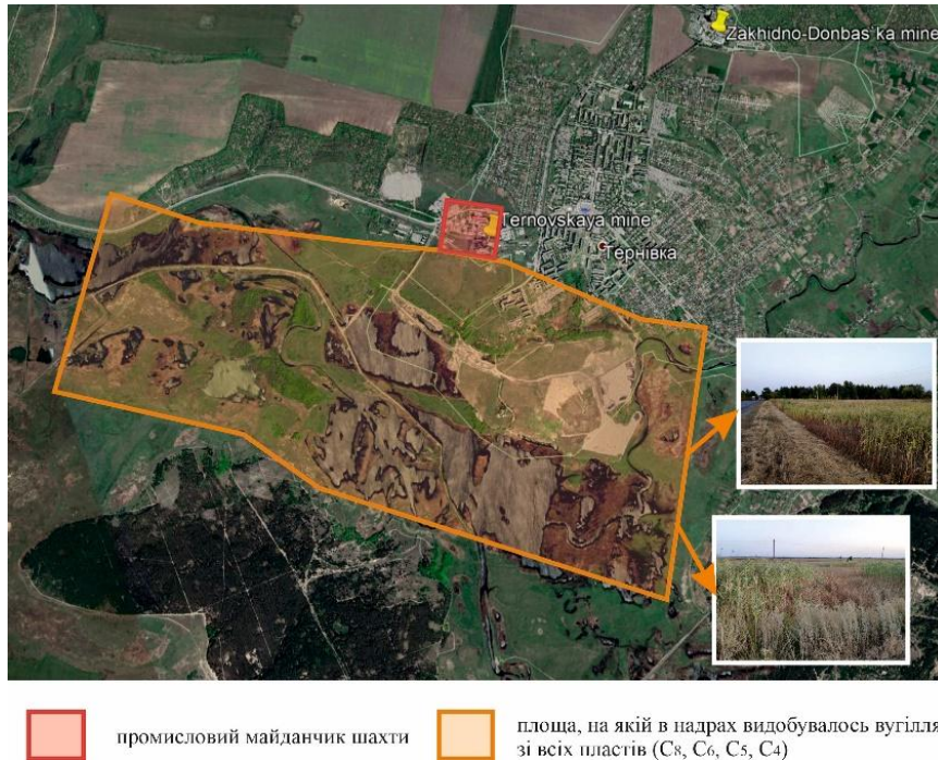
Рис. 1. Ілюстрація екологічних наслідків підземного видобутку вугілля поблизу міста Тернівка та села Богданівка: просідання й заболочування денної поверхні
