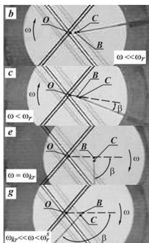
На рис. 1 представлены экспериментальные данные визуализации положений следов центра масс, вала и оси вращения неуравновешенного дискового ротора в выбранной плоскости измерений. На рис. 1b показан докритический режим вращения ротора на скорости значительно меньшей критической. След центра масс ротора C отстоит от следа вала B на величину эксцентризитета, а вал от следа оси вращения O на величину прогиба. Точки C, B и O лежат на одной прямой.
