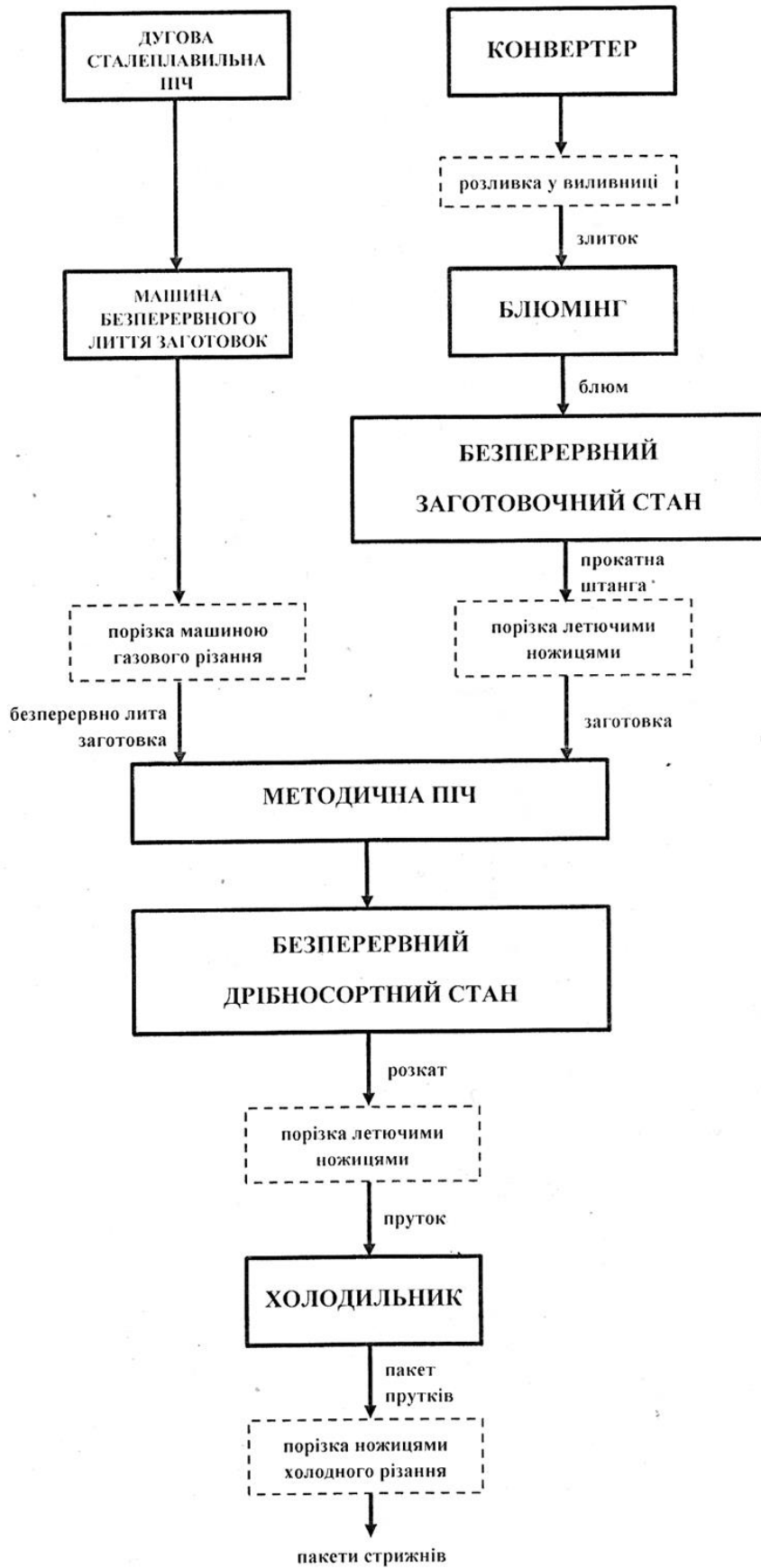
Рисунок 1.1 - Структурна схема виробництва дрібносортного металопрокату
