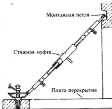
Рис.6. Схема тимчасового кріплення стінових панелей підкосом
