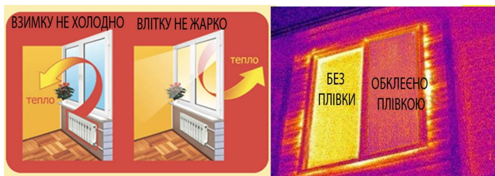
Рисунок 4.4 – Принцип роботи теплозберігаючої плівки
