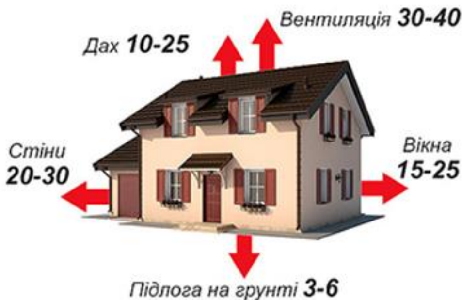
Рисунок 4.1 – Структура теплових втрат для будівлі
