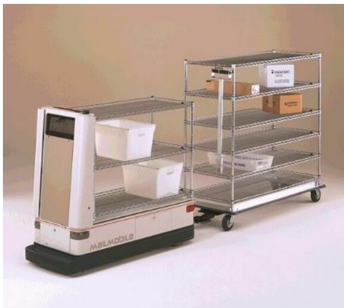
Рисунок 1.6 – Приклад системи AVG для транспортування їжі у ресторанах
