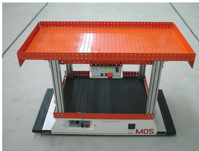
Рисунок 1.5 – Приклад системи AVG для транспортування вибухової речовини
