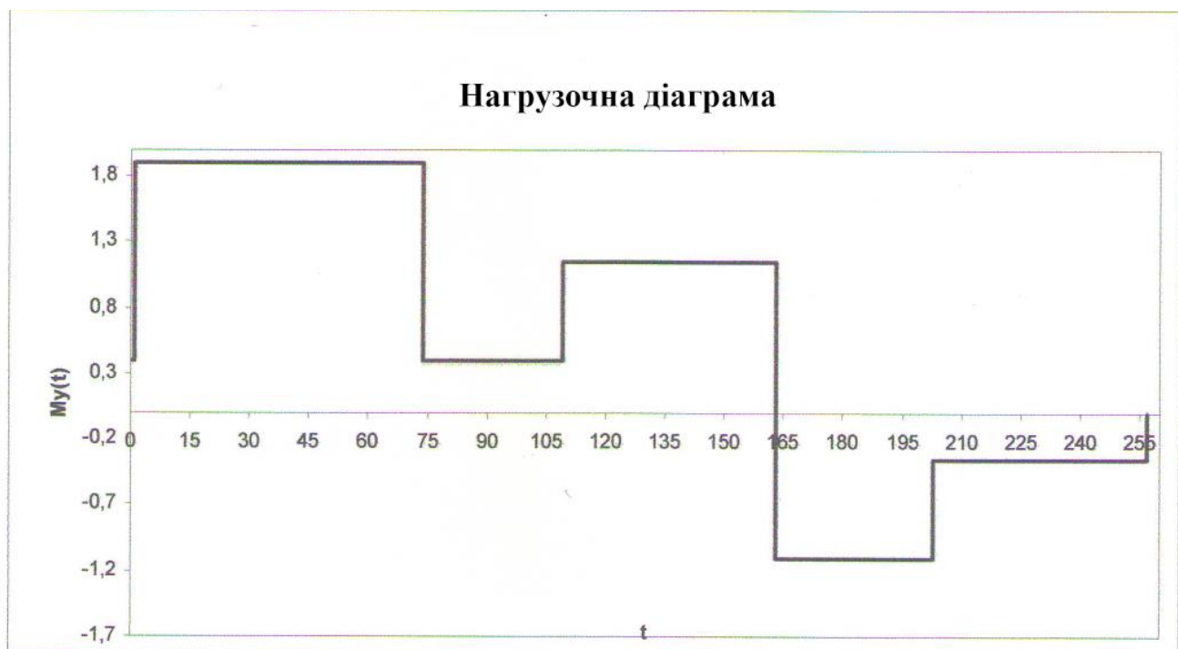
Мал.2.6. Діаграма навантаження приводу подачі у час фрезерування
