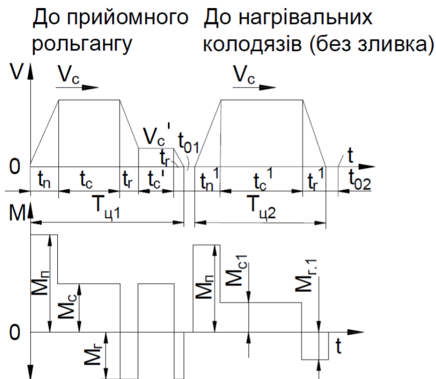
Рисунок 1.4 – Тахограма і навантажувальна діаграма механізму переміщення слитковоза
