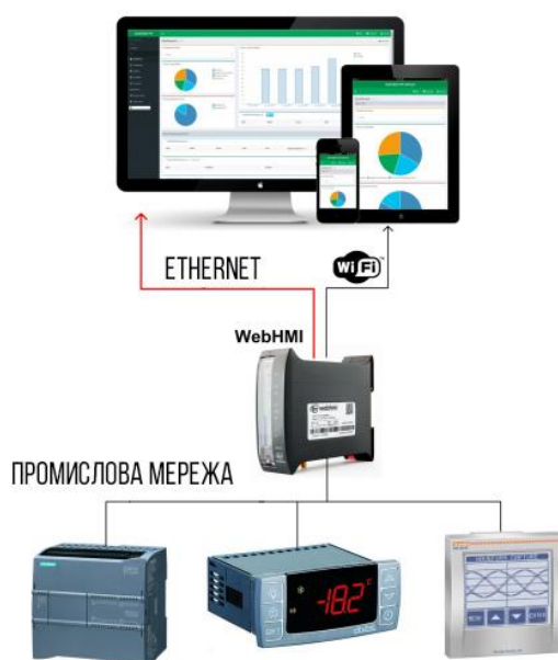
Рис. 1.6 Структурна схема керування пристроями за допомогою Wi-fi та Ethernet
