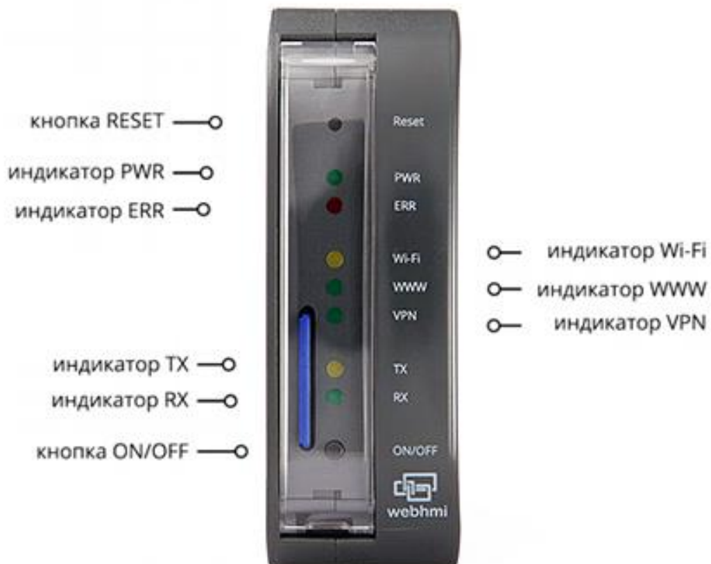
Рис 3 Лицева панель пристрою. Елементи зовнішньої індикації
