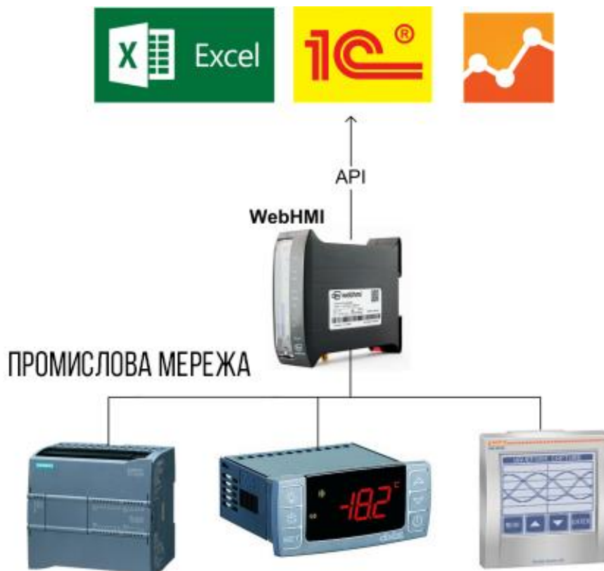
Рис. 1.12 Структурна схема передачі даних за допомогою вбудованого API
