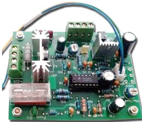
Рисунок 2.6 – Схема регулятора обертів на базі мікросхеми TDA1085
