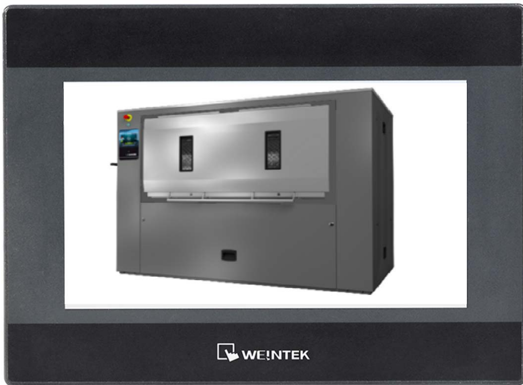
Рисунок 2.6 – НМІ-Панель оператора Weintek MT8071iE, 7"
