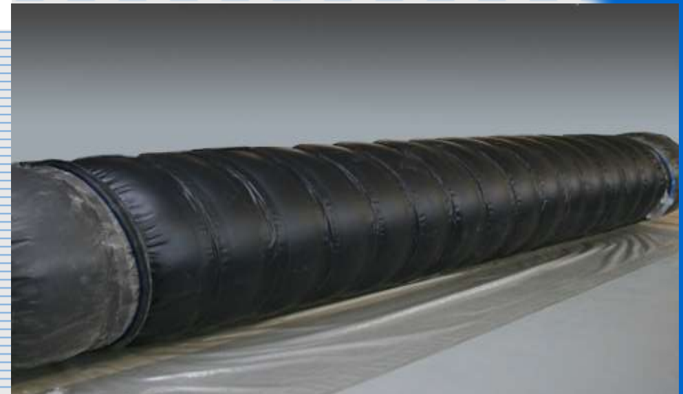
Загальний вигляд армованої вентиляційної труби
