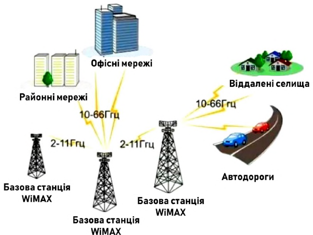
Рисунок 1.2 - Схема принципу роботи WiMAX
