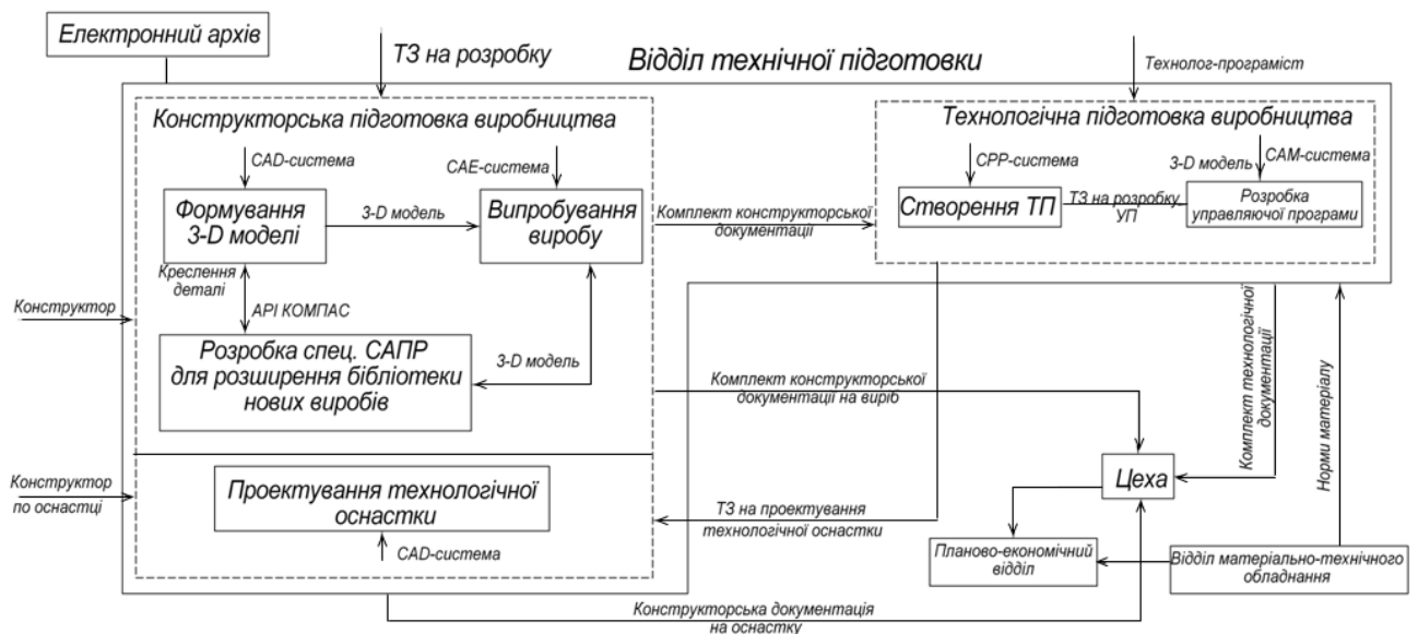
Рис.1.3. Функціональна схема автоматизованого проектування
