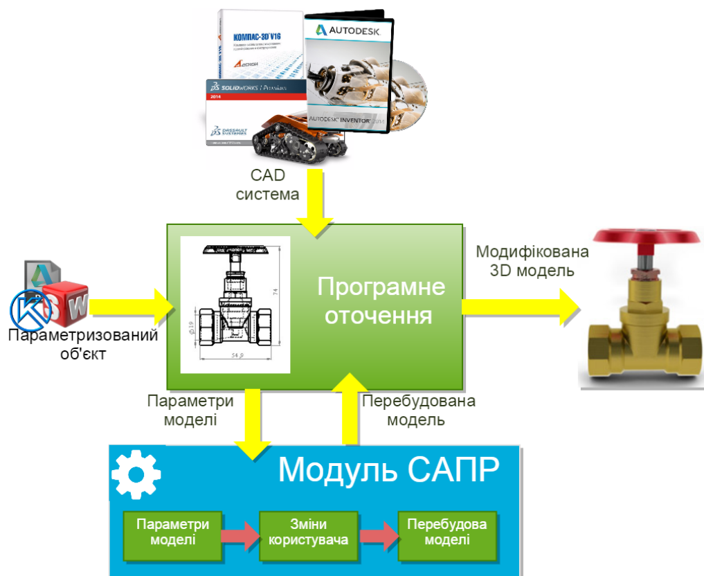
Рис.2.3. Схематичний алгоритм роботи програмного модуля САПР
