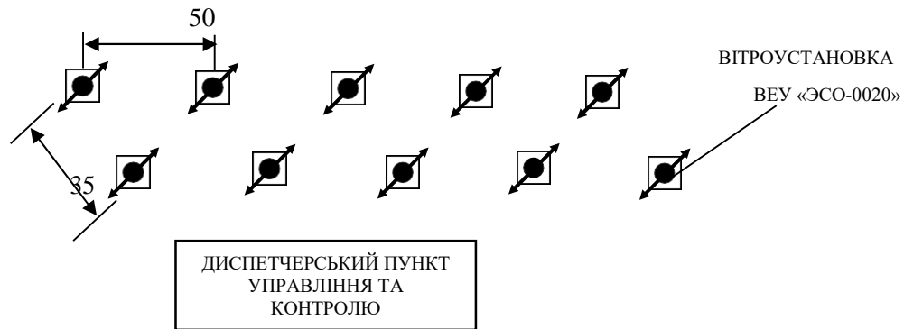
Рисунок 3.2 – Структура вітростанції вертикально-осьових вітроустановок ВЕУ «ЭСО-0020»
